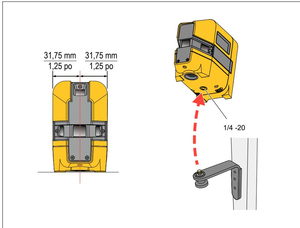
**Figure 1. Point central et support d'accessoires**
