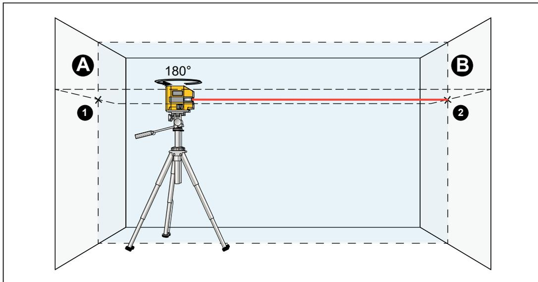
3. Tournez l'outil à 180°, laissez-le effectuer le nivellement et marquez le point avant du laser sur le mur B opposé (point 2).
