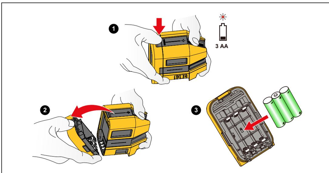
Figure 8. Remplacement des piles
