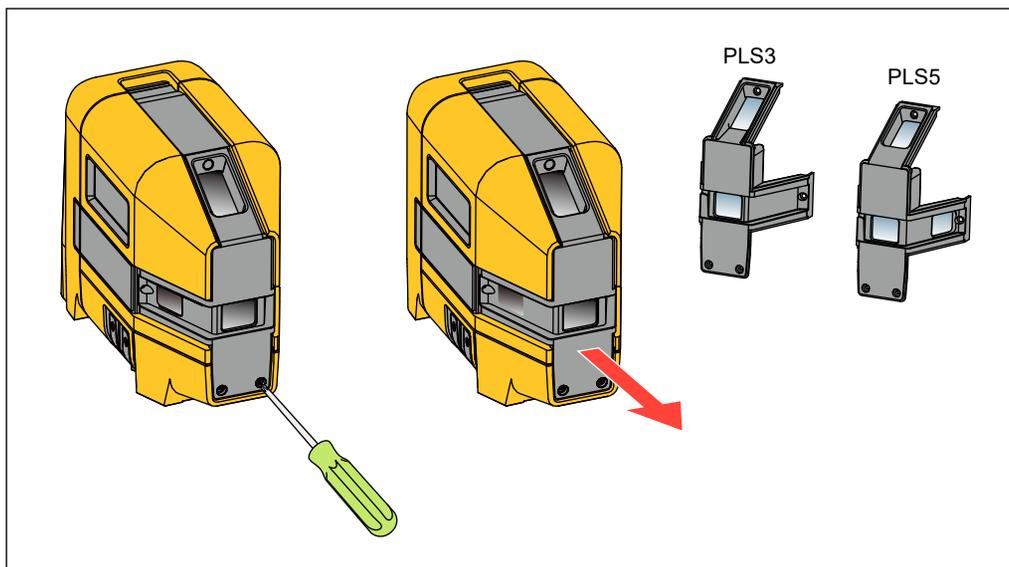
**Figure 9. Remplacement de l'élément à fenêtres du boîtier**
