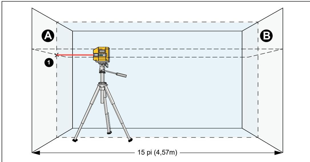
2. Tracez une ligne verticale sur le mur A et dirigez le laser avant de sorte qu'il soit aligné avec la ligne tracée. Laissez l'outil effectuer le nivellement. Marquez ce point sur le mur (point 1).
