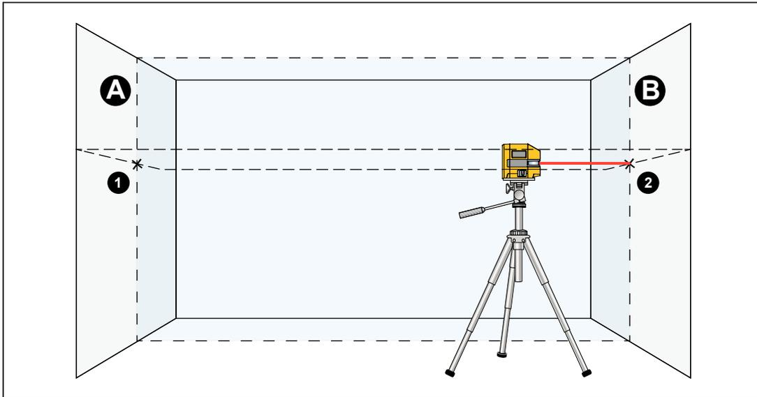
5. Alignez la hauteur de l'outil (à l'aide d'un trépied ou en plaçant un élément en-dessous, si nécessaire) de sorte que le point avant du laser soit projeté contre le point **2** précédemment marqué sur le mur B.
