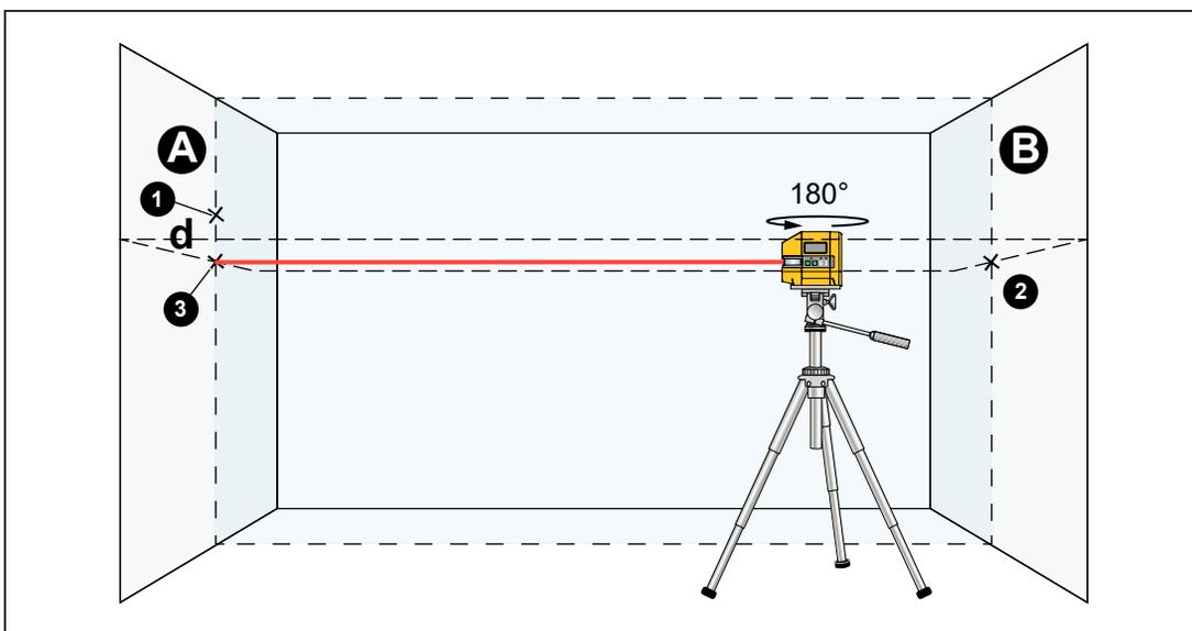
6. Sans changer la hauteur, retournez l'outil à 180°. Dirigez-le contre le mur A de sorte que la ligne du laser vertical passe par la ligne verticale tracée avec le point **1**.
