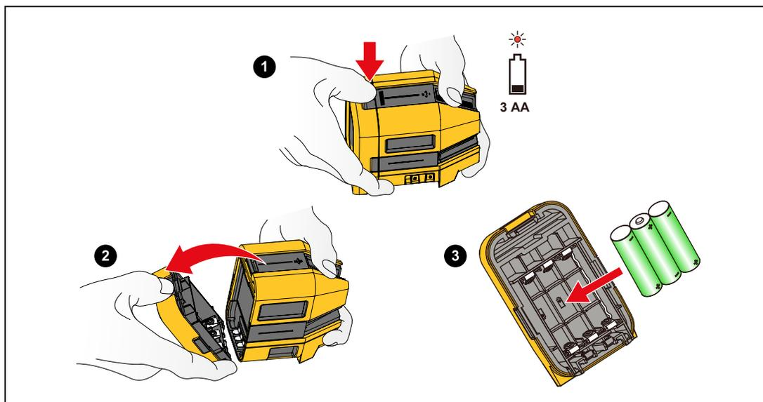
Figura 8. Sostituzione delle pile
