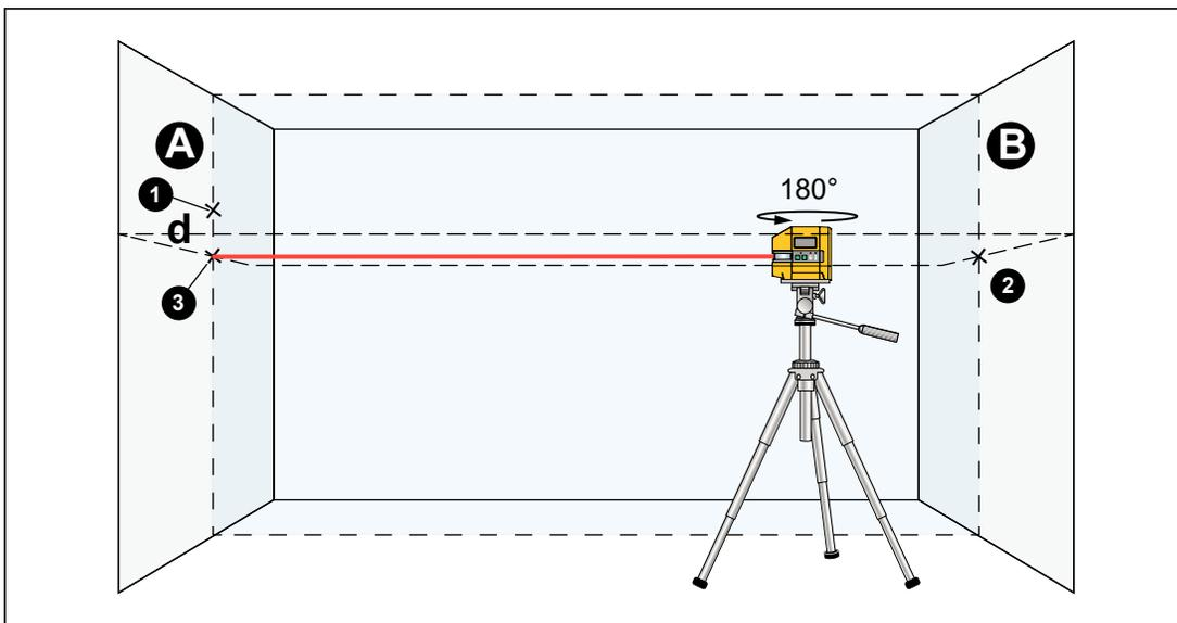
6. Senza modificarne l'altezza, ruotare lo strumento di 180°. Puntarlo verso la parete A in modo che la linea verticale del laser scorra attraverso la linea verticale disegnata con il punto **1**.
