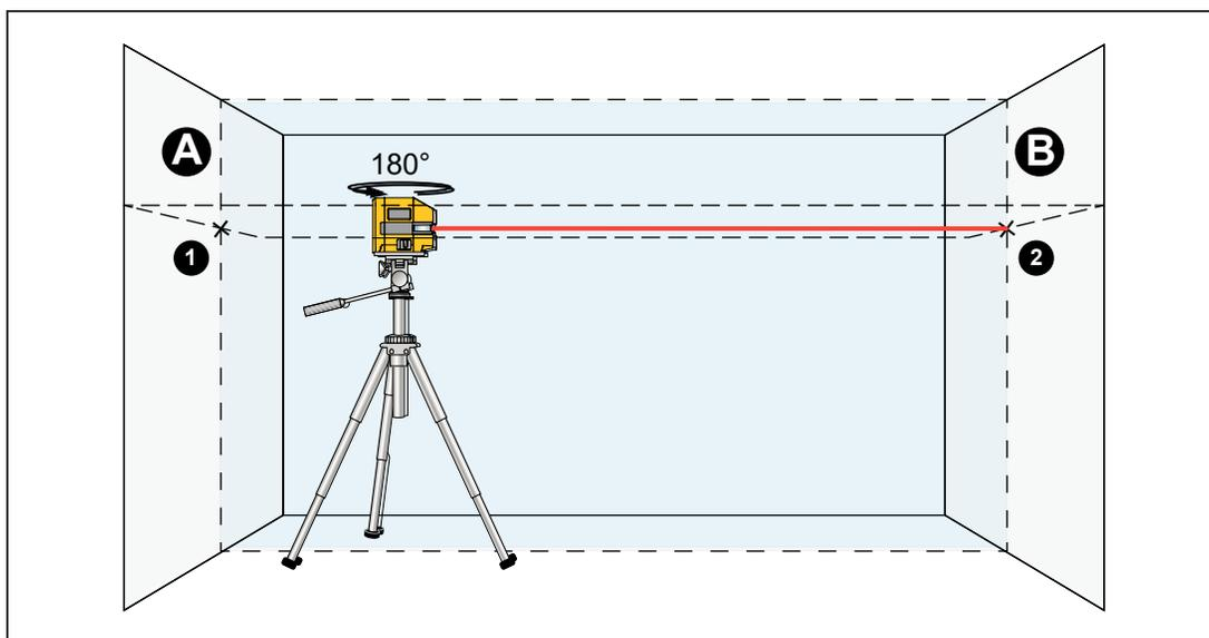
3. Ruotare lo strumento di 180°, lasciarlo livellare e contrassegnare il punto anteriore del laser sulla parete B opposta (punto 2).
