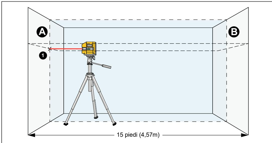
2. Disegnare una linea verticale sulla parete A e puntare il laser anteriore in modo che sia allineato alla linea. Lasciar livellare lo strumento e contrassegnare questo punto sulla parete (punto 1).
