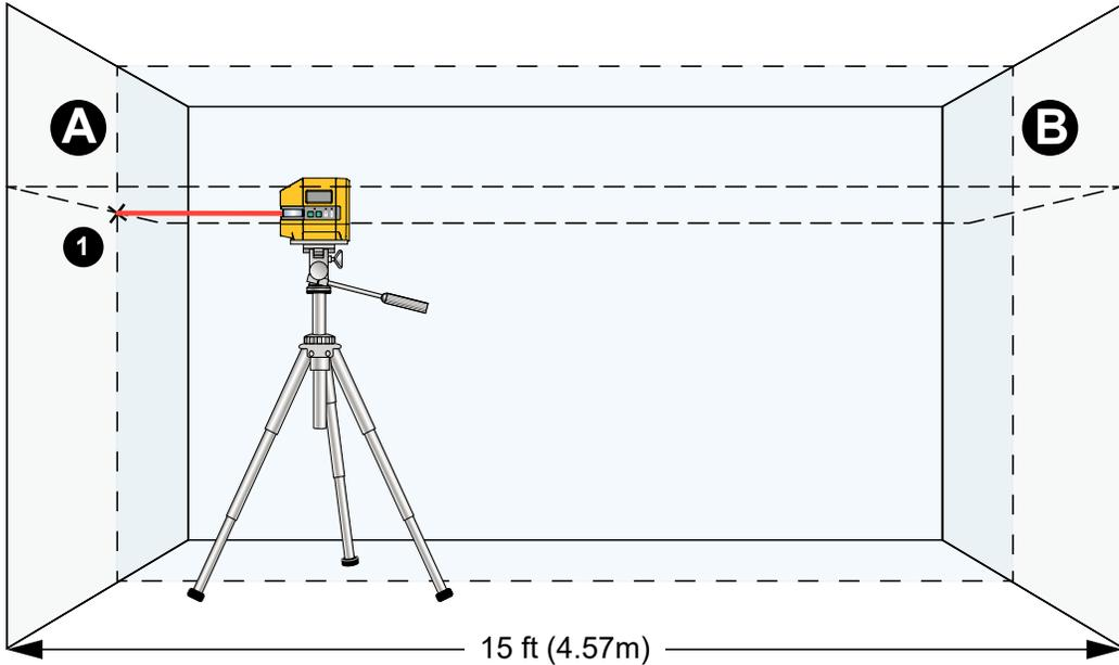
2. 레이저를 벽면 A 에 가리키고 도구가 수평을 유지하게 합니다 . 벽면에 레이저선이 서로 교체하는 포인트 가운데를 표시합니다 ( 포인트 ① ).
